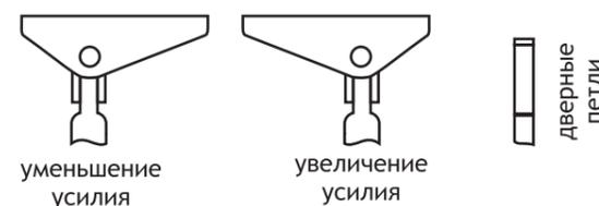
Дополнительно можно настроить усилие закрытия ( $\pm 5\%$ ), переворачивая кронштейн регулируемого рычага. Для уменьшения усилия необходимо расположить ось рычага дальше от петель. Для увеличения усилия - ближе. (Пример для двери правого исполнения).
